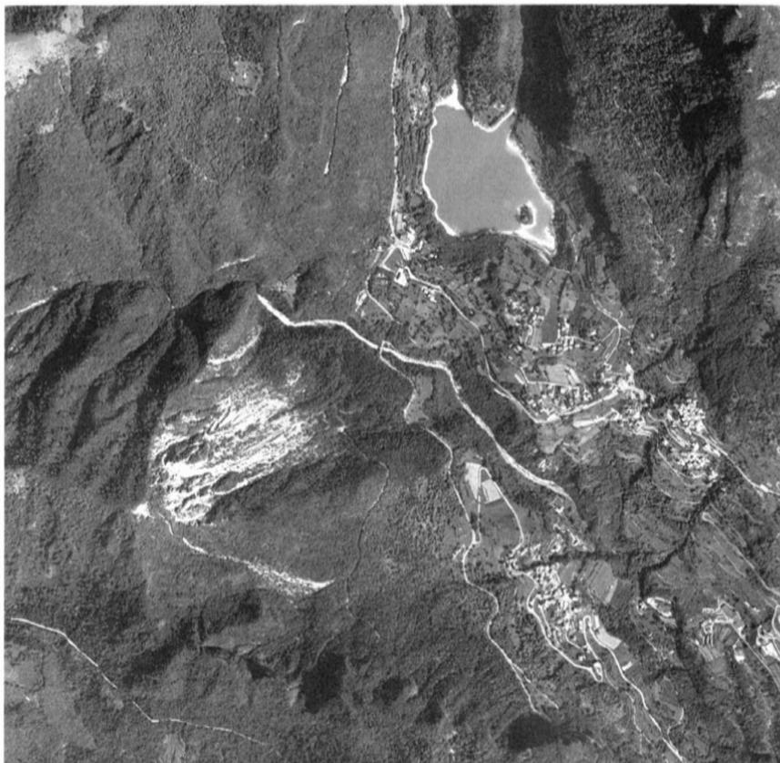
Fig. 25 - Ortofoto della zona di Tenno prima della frana del Novembre 2000. Si noti l'ampia nicchia di Cima Salti e parte dell'accumulo nei pressi della morena che sostiene il Lago di Tenno.
