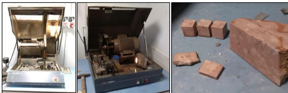
Figura 53: Da sinistra: Struers Unitom-2 per grandi tagli; Struers Labotom-3 per piccoli tagli; campioni tagliati
