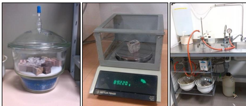
Figura 55: Da sinistra: asciugatore, bilancia di precisione, pompa per il sottovuoto
