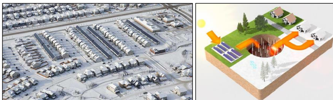
Figura 10: Fotografia aerea della Drake Landing Solar Community (sx) e configurazione dello storage BTES, fonte Rehau (dx)
