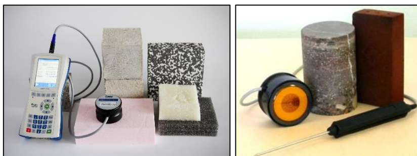
Figura 56: Lo strumento ISOMET 2114, utilizzato per le analisi termiche
