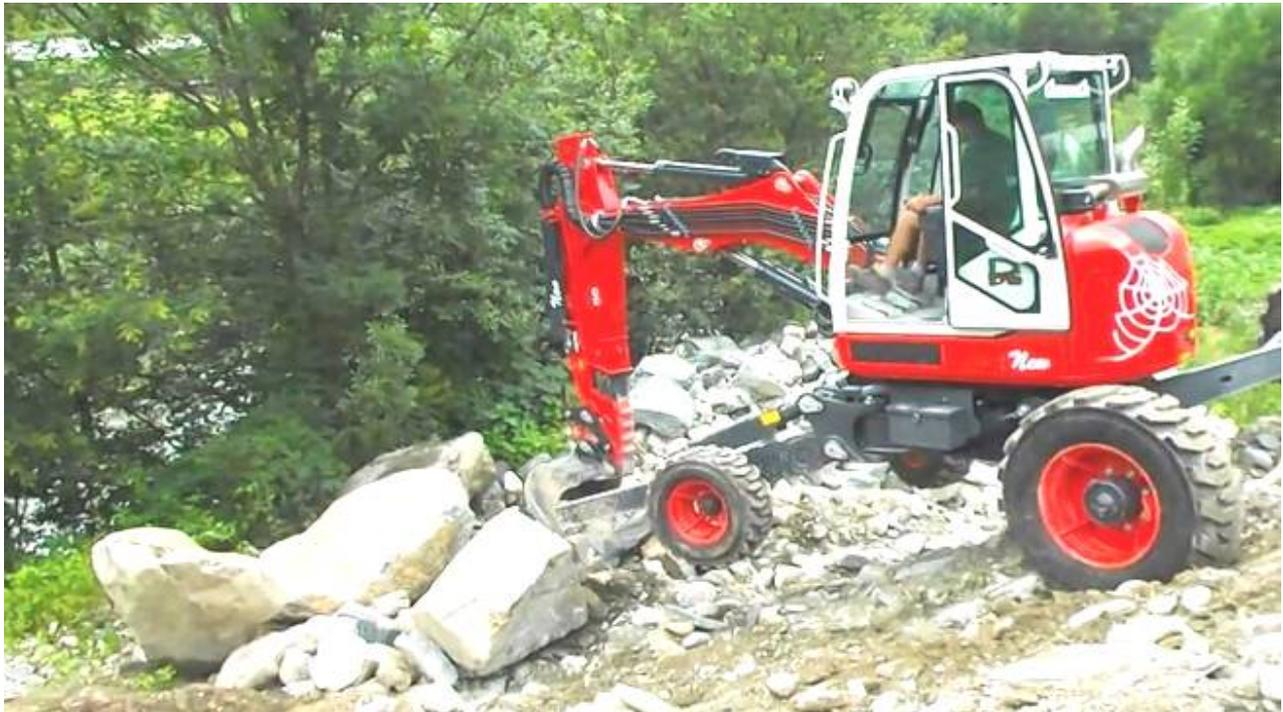
Trattasi della formazione di rilevati mediante utilizzo di detriti e massi provenienti dalla demolizione del diedro. Si prevede:
